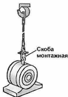
Скоба монтажная СТРОПОВКА ЭЛЕКТРОДВИГАТЕЛЯ ДВУХПЕТЛЕВЫМ СТРОПОМ
