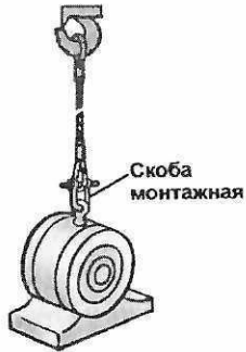
Скоба монтажная СТРОПОВКА ЭЛЕКТРОДВИГАТЕЛЯ ДВУХПЕТЛЕВЫМ СТРОПОМ
