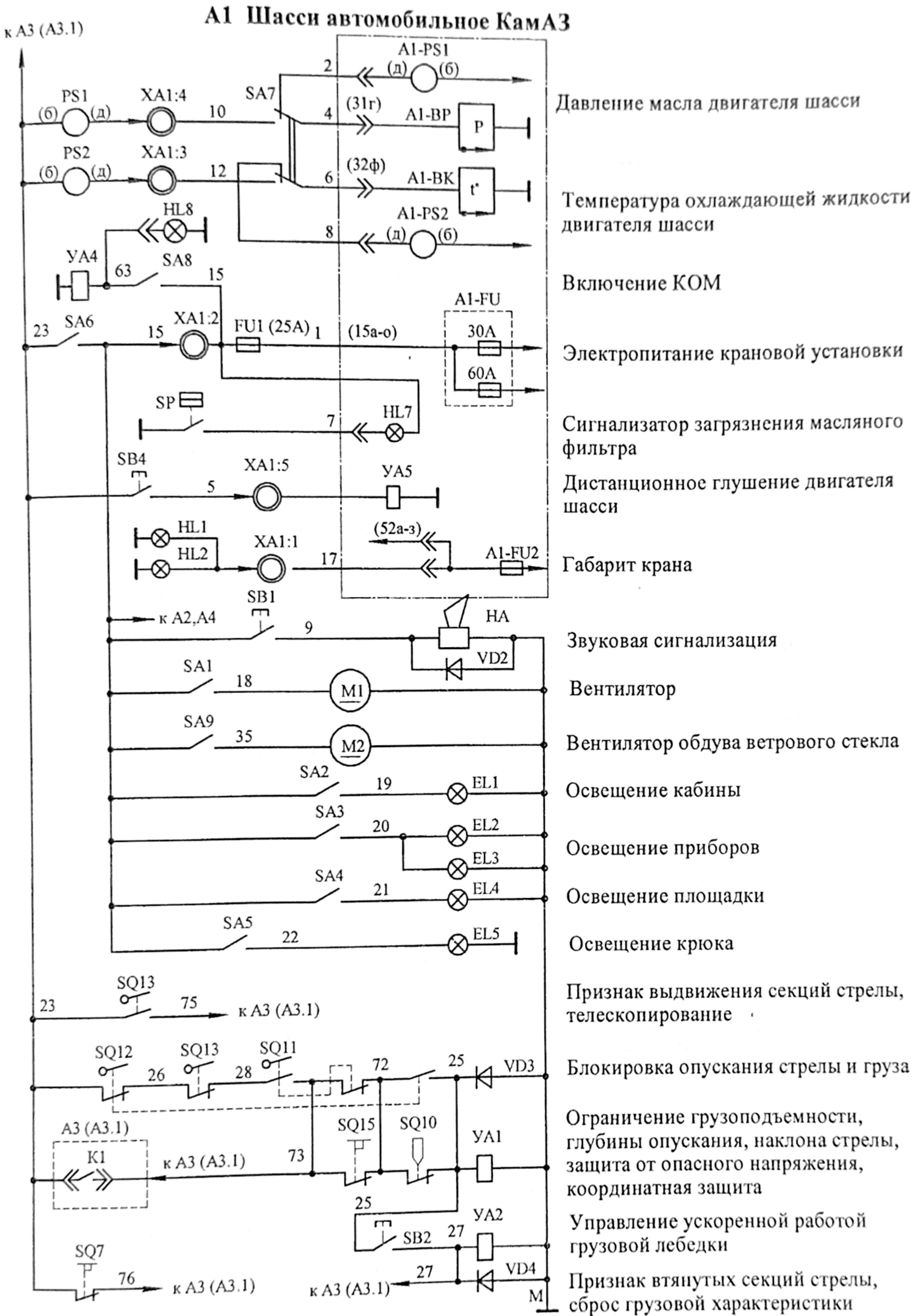
Рисунок 6 – Схема электрическая принципиальная (Лист 1)
